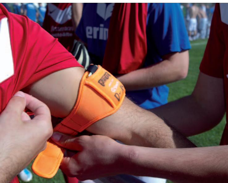
Die 22 Gramm schweren GPS-Logger kann gut drei Stunden betrieben werden und ermöglicht dabei maximal fünf Positionsermittlungen pro Sekunde.
